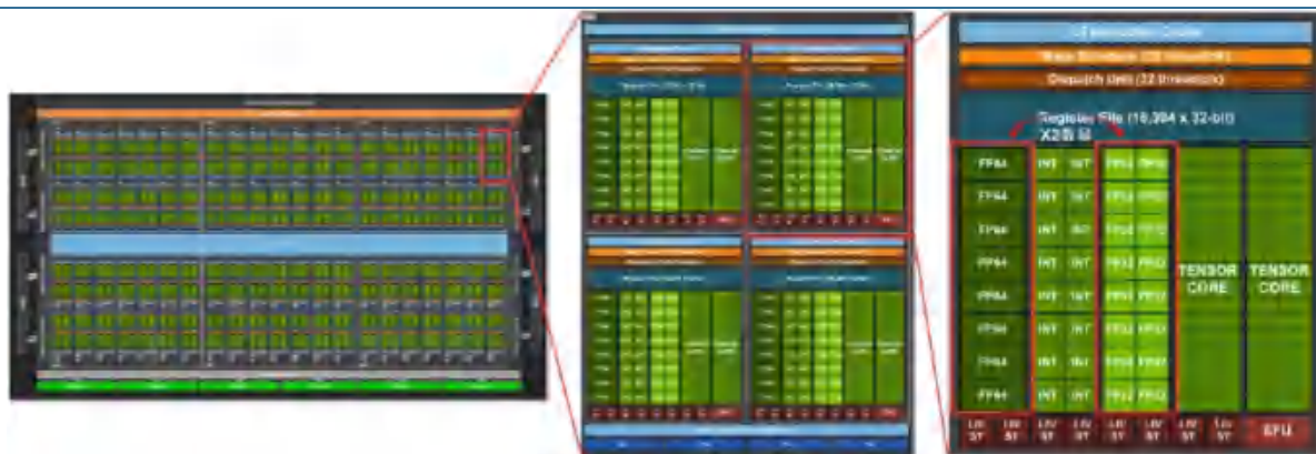
图表18：V100 中 FP32 硬件单元和 FP64 硬件单元的数量关系
