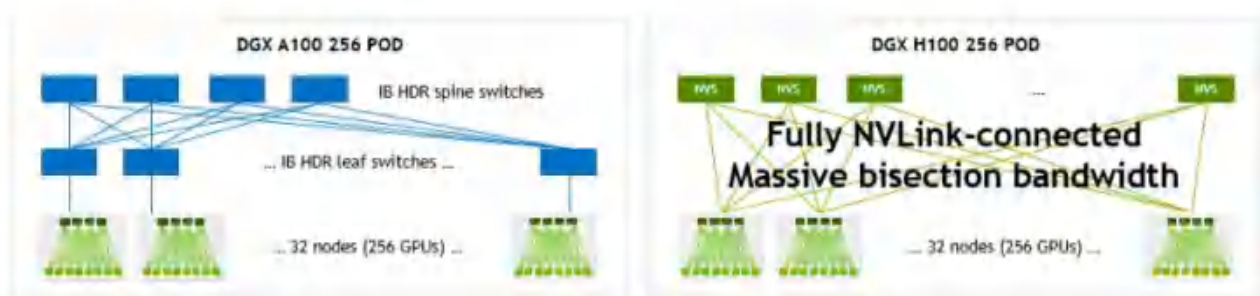
图表122： A100 和 H100 POD 采用 IB 和 NVLink 网络的示意图
