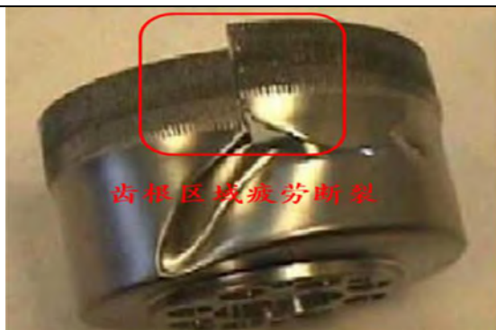
图22. 柔轮疲劳损伤断裂示意图
