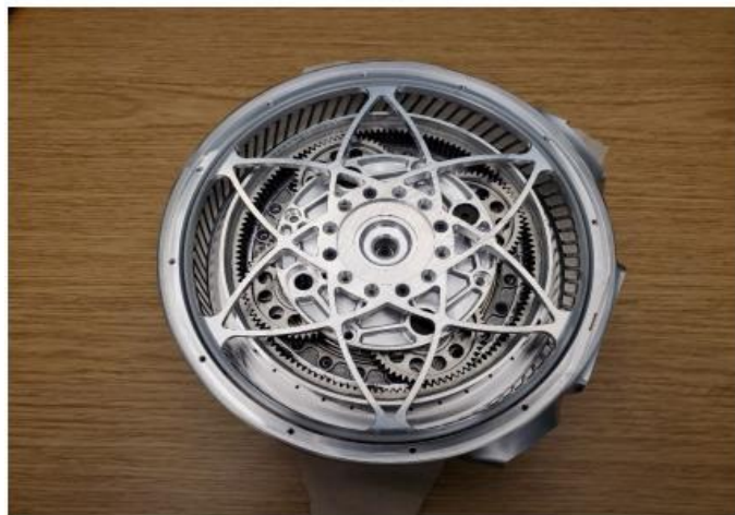
图30. UCLA Zhu.Taoyuanmin 博士设计并使用在人形机器人上的行星齿轮箱
