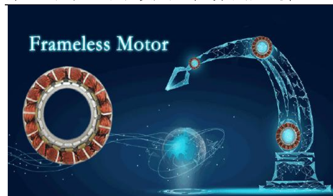
图19. 无框力矩电机能够很好地集成于机器人关节
