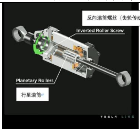
图53. Optimus 线性执行器剖面图 1 螺母螺杆
